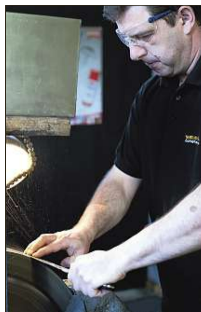
Der mit einer Schleifemulsion gekühlte Stein sorgt für den Vorschleiff.
