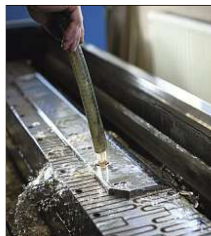
Mit dem Ölgemisch wird die schwere Klinge nach dem Schleifen sauber.
