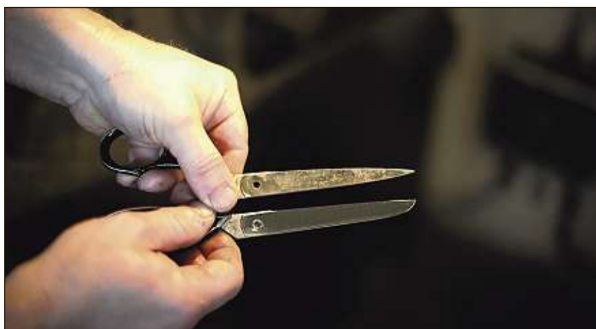
Vorher (oben) – nachher (unten): Bereits nach dem ersten Arbeitsgang ist die von Alexander Seidel zerlegte Schere wieder blank – und bald auch scharf.
